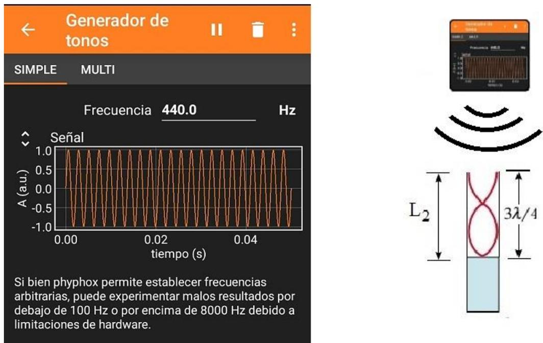
**Figura 6:** Generador de audio. Experimento de resonancia del sonido en un tubo.
