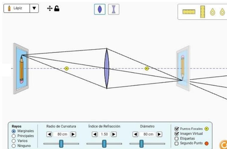
**Figura 4:** Simulación sobre obtención de imágenes en lentes delgadas.
