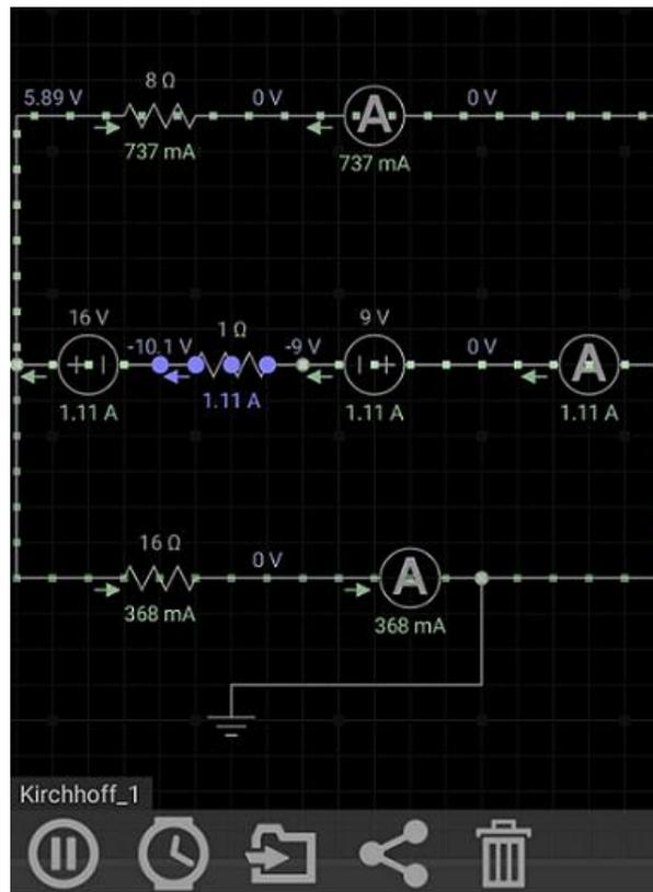
**Figura 5:** Ventana de trabajo del simulador de circuitos EveryCircuit.
